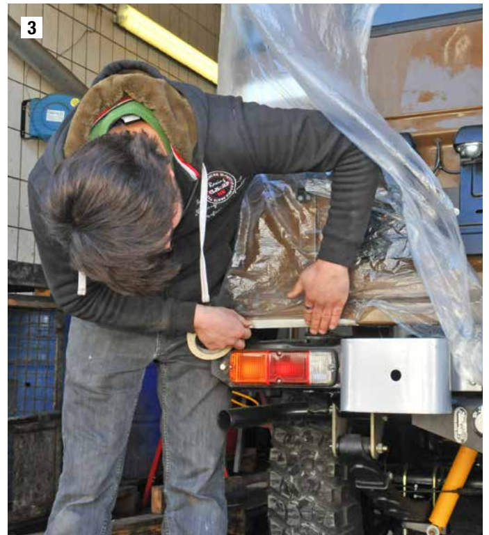
3 Mit einer handelsüblichen Malerfolie und Klebeband wird die Karosserie unseres Probanden sorgfältig abgeklebt – je genauer das geschieht, desto einfacher sind die Reinigungsarbeiten zum Schluss.
