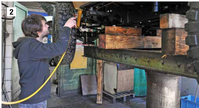
2 Nach einstündiger Abtrockenzeit werden Hohlräume und feuchte Stellen mit Druckluft ausgeblasen. Wasserflecken müssen entfernt werden!
