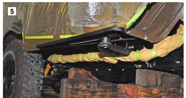
5 Protektion muss sein! Die komplette Auspuffanlage muss ebenfalls vor den wachs- und ölhaltigen Produkten geschützt werden.
