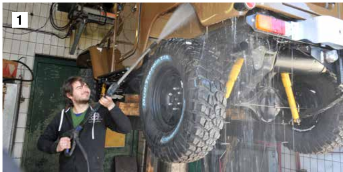
1 Großer Waschtag: Das zu behandelnde Fahrzeug sollte vor Beginn der Operation mit dem Hochdruckreiniger von Dreck und Salzurückständen gereinigt werden.
