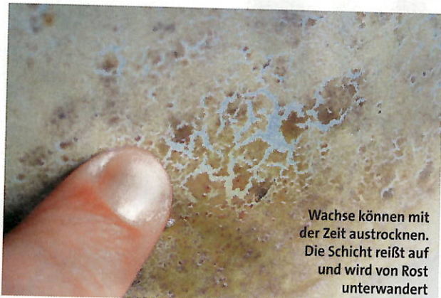
Bei diesem Testschweller war die Kriechwirkung eines Wachses unzureichend
