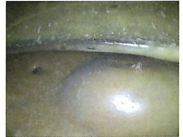
Noch ein Blick mit der Mini-Kamera durchs Schlüsselloch: Links ist das angerostete Blech zu sehen, rechts hat eine dicke Fettschicht die Oberfläche komplett abgedeckt
