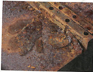
Bei diesem Testschweller war die Kriechwirkung eines Wachses unzureichend
