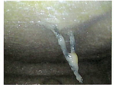
Die Endoskop-Aufnahmen aus einem Schweller zeigen die ideale Wirkung von Hohlraumfett: Der von einer Reparatur übrige Schweißdraht wird eingekapselt
