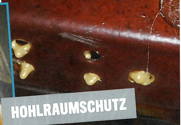
Rost an der Schiebetür eines Mercedes Sprinter. Zeitaufwand: vier bis sechs Stunden
