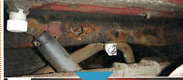
Längsträger eines Ford Transit mit schweren Rostschäden. Zeitaufwand: etwa zehn Stunden
