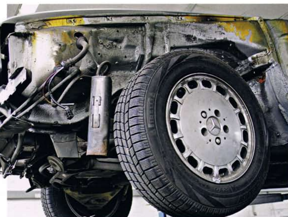
Gestrippt: Dieser Mercedes wurde für Schweißarbeiten im Radkasten vorbereitet.
