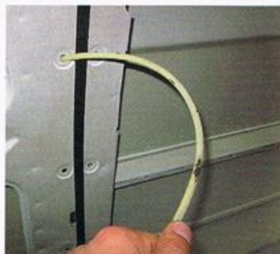
Rückleuchten und Innenverkleidung des T3 sind entfernt – Hohlräume und Falze sind nun gut zugänglich
