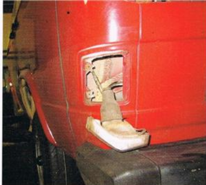
Rückleuchten und Innenverkleidung des T3 sind entfernt – Hohlräume und Falze sind nun gut zugänglich
