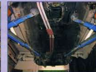
Wir sehen schwarz: Der gesamte Unterboden wird von Bitumen befreit
