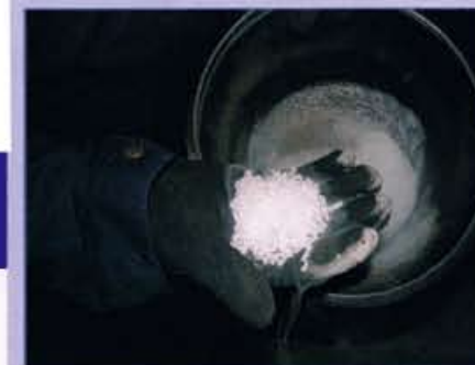
Bloß nicht mit der Hand anfassen: das Strahlmittel aus gefrorenem Kohlendioxid
