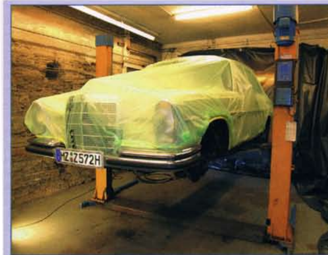
Vor dem Strahlen mit Trockeneis werden alle Partien, die nicht behandelt werden sollen, mit Folie abgeklebt – als Schutz vor Verschmutzungen
