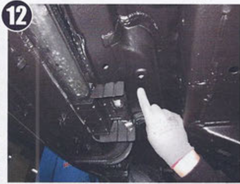
12 Liebe zum Detail: Wenn Gerd Cordes ein Fahrzeug konserviert, bleiben die vorgegebenen Wasserabläufe – weil der Mann ganz genau weiß, wozu sie gut sind.
