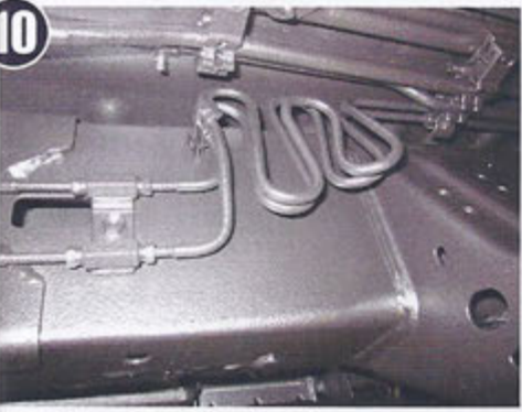
10 Unauffällig: Wenn man den Farbton Schwarz wählt, kann man alle Leitungen mitbehandeln. Besonders Bremsleitungen sind durch Witterung stark korrosionsgefährdet.
