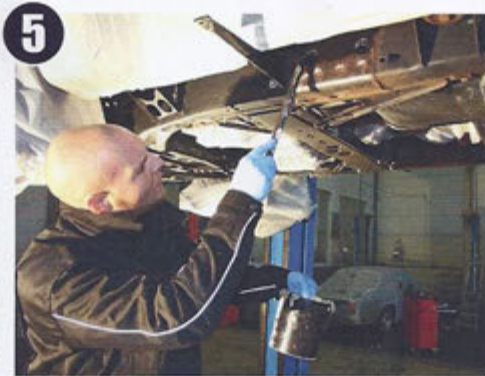
5 Voranstrich für extreme Rostzonen: An rostigen Problemstellen wird der Unterbodenschutz fest mit einem Pinsel in den vorhandenen Rost „reingerieben“.
