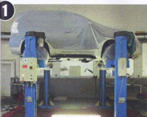
1 Japanische Pyjama-party: Bevor die Arbeiten am Unterboden in Angriff genommen werden können, wird der Land Cruiser J15 sorgfältig in Schutzfolie verpackt.
