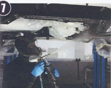
7 Generalangriff: Die Sprühlackierung erfolgt – je nach Baugruppe – entweder mit einer groß bedüsten Lackierpistole oder einer Unterbodenschutzpistole mit kleiner Bedüsung.
