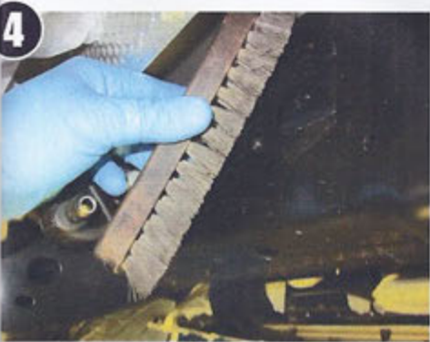
4 Vorarbeiten: Die Schuhputzbürste hat nur symbolischen Wert. Im Idealfall wird der Unterboden vor der Behandlung mit Trockeneis gestrahlt.
