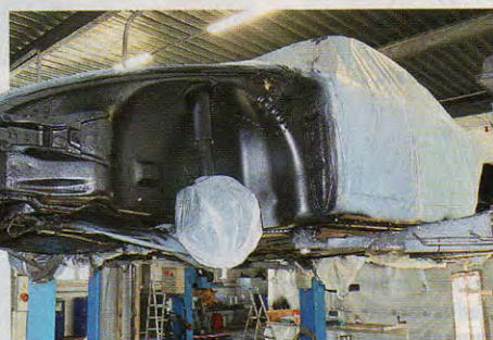
Schwarzarbeit abgeschlossen: Mit der zweiten Spritzschicht glänzt der Porsche unterwärts in dunklem Kleid. TimeMax Color ist so dünn, ...
