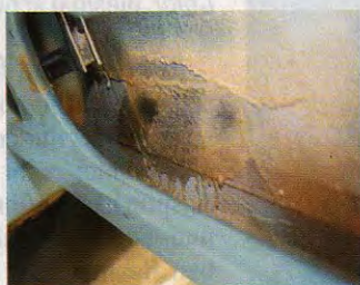
... überall hineinläuft und auch nach dem Erkalten kriechfähig bleibt. Was überschüssig ist, ...
