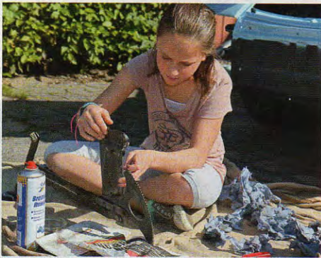
Altfett adieu: Vorm Wiedereinbau reinigt Smilla die Fensterheber. Denn zur Hohlraumbehandlung sollten die Türen inwärts zusammengebaut sein
