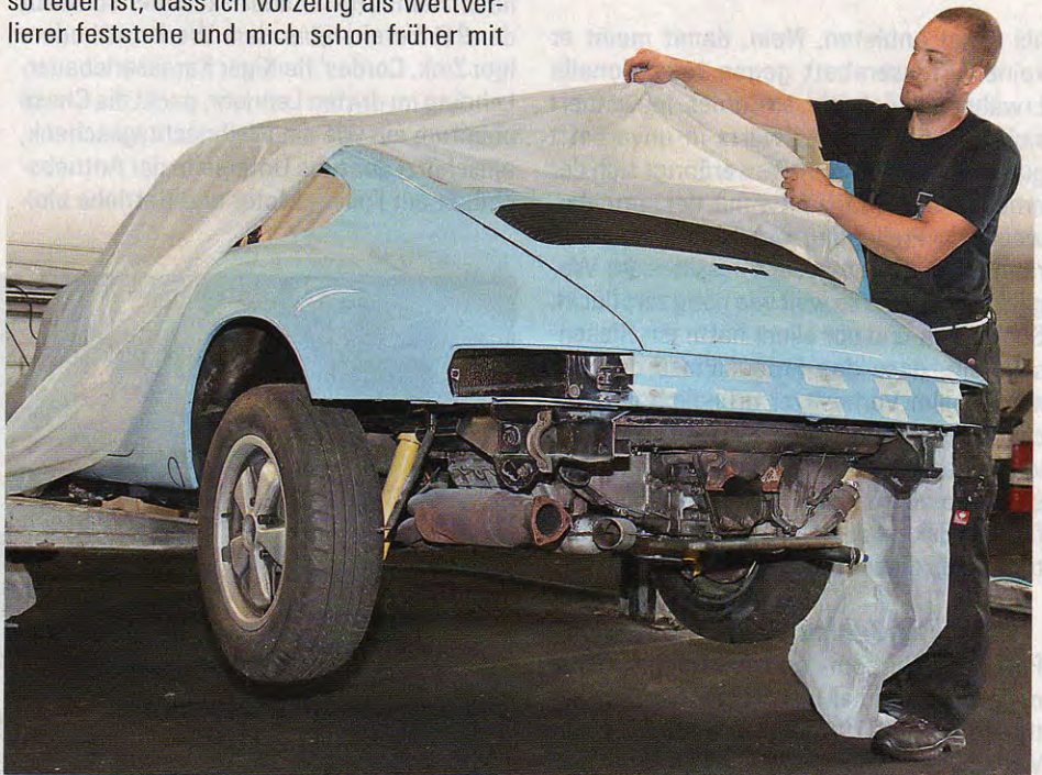
Verhüllungskunst: Vor der Unterbodenbehandlung klebt TimeMax-Lehrling Igor Zink das Lackkleid des 911 mit einer Folie ab. Der Auspufftopf ist zur Erreichbarkeit der Heck-Quertraverse demontiert
