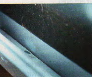
Trotz Tauchbad und KTL. Rost im Falz – ein Fall für Flüssigfett, das ...
