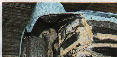
Viel hilft viel: Nähte wie Falze stehen im Saft – und auch viele Fahrwerkerteile haben ihr Fett wegbekommen, wie hier am Vorderwagen ...
