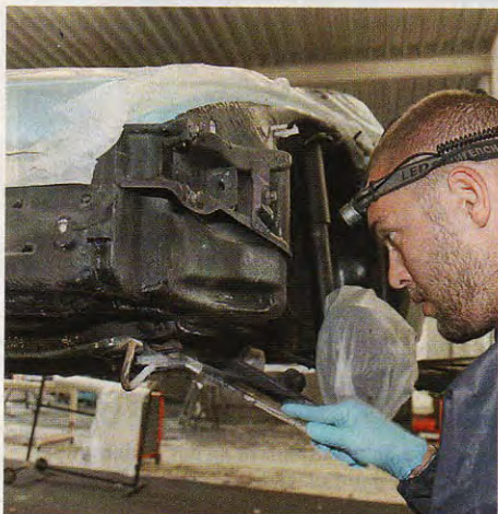
Vorstrich: Rostige Stellen, hier die linke Schleppöse, werden per Farbpinsel mit TimeMax Color vorbehandelt, ...
