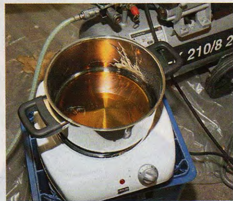
Vorsicht, heiß und fettig: das Hohlraumpräparat im entführten Familienkochtopf bei 100 Grad. Dahinter: Aldi-Heimkompressor für 79,99 Euro
