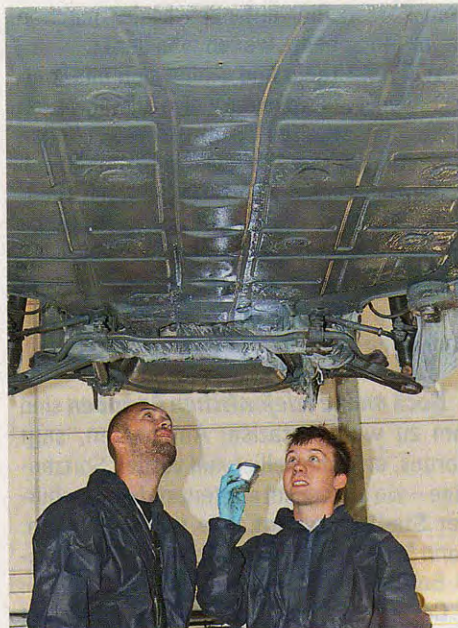
Graue Theorie: Igor Zink und Karosseriebauer-Meister Eric Hütter (re.) überprüfen die erste Schicht TimeMax Color auf Vollständigkeit
