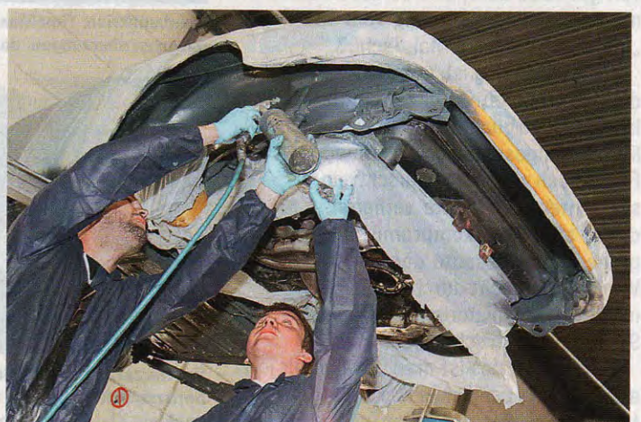
Vorstrich: Rostige Stellen, hier die linke Schleppöse, werden per Farbpinsel mit TimeMax Color vorbehandelt, ...
