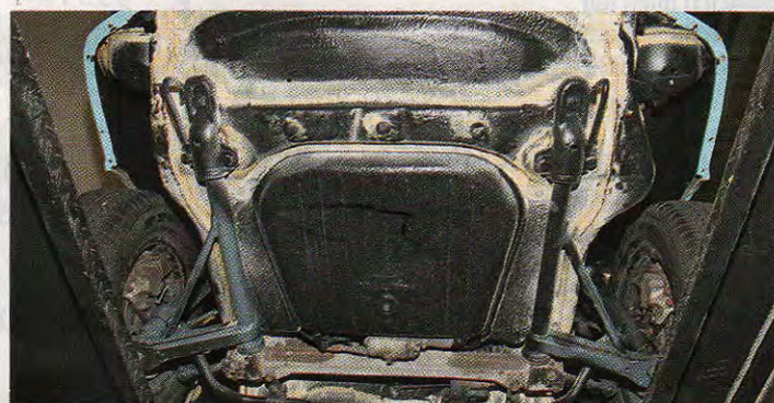
Ende der Ästhetik: Nachbehandlung der Nahtstellen am 911- Boden mit Fett – nicht schön, aber für den Winterbetrieb des Porsche-Klassikers allemaal sinnvoll. Denn das Fett kriecht auch in jene Bereiche, die im Spritzschatten der Anbauteile liegen
