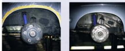
Beispiel Porsche 356 B Roadster von 1961: Alter und versprödeter Unterbodenschutz wird schonend mit Trockeneis entfernt.
