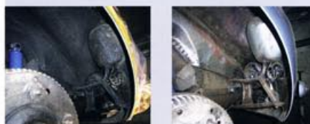
Beispiel Porsche 356 B Roadster von 1961: Alter und versprödeter Unterbodenschutz wird schonend mit Trockeneis entfernt.
