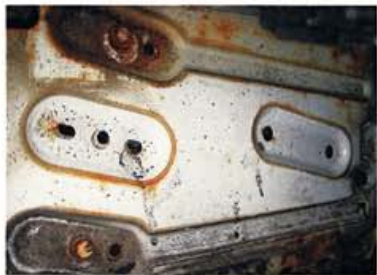
Ähnlich schützt Cordes den Unterboden: Der gelben Epoxidharz-Grundierung folgt eine graue. Dann trägt der Profi den schwarzen Schutzlack auf und schließlich das Fett – auch hier bis zu drei verschiedene Sorten. Mit einer vierten gummi-verträglichen setzt der Hamburger zuvor entfernte Karosseriestopfen und Dichtungen ein.
