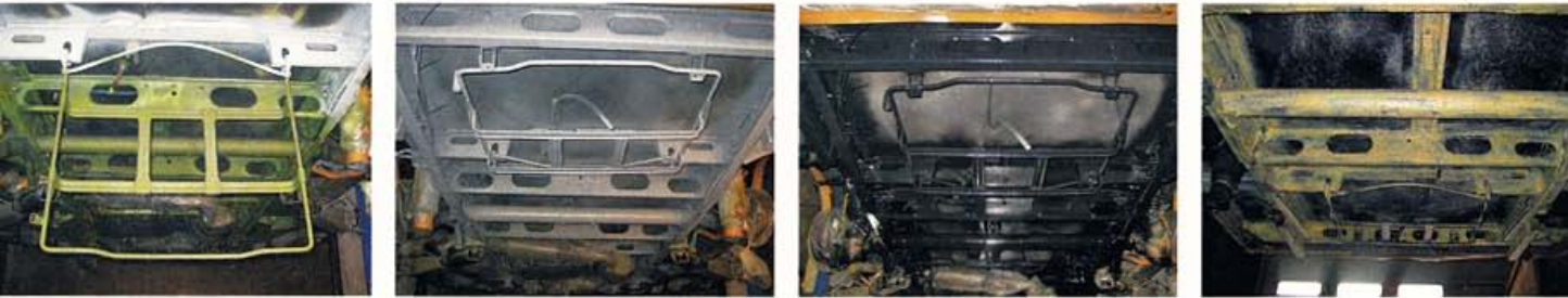
Ähnlich schützt Cordes den Unterboden: Der gelben Epoxidharz-Grundierung folgt eine graue. Dann trägt der Profi den schwarzen Schutzlack auf und schließlich das Fett – auch hier bis zu drei verschiedene Sorten. Mit einer vierten gummi-verträglichen setzt der Hamburger zuvor entfernte Karosseriestopfen und Dichtungen ein.
