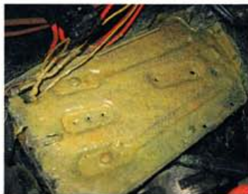
Ähnlich schützt Cordes den Unterboden: Der gelben Epoxidharz-Grundierung folgt eine graue. Dann trägt der Profi den schwarzen Schutzlack auf und schließlich das Fett – auch hier bis zu drei verschiedene Sorten. Mit einer vierten gummi-verträglichen setzt der Hamburger zuvor entfernte Karosseriestopfen und Dichtungen ein.
