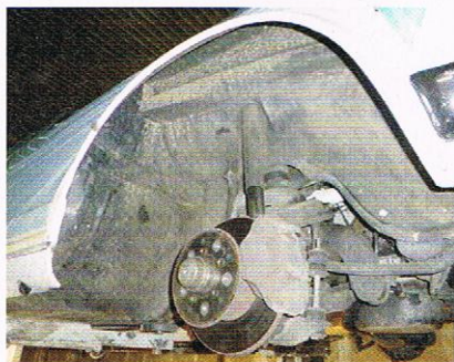
Das Radhaus vorne links sieht vor dem Trockeneisstrahlen gar nicht schlecht aus. Der Schein trügt.
