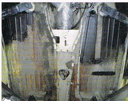
Die Unterbodenschutz-Beschichtung mit TimeMAX COLOR. Zuerst wird in Grau und dann in Schwarz lackiert. Durch die unterschiedlichen Farbtöne kann der Mechaniker sofort erkennen, ob er alle Stellen deckend erreicht hat.
