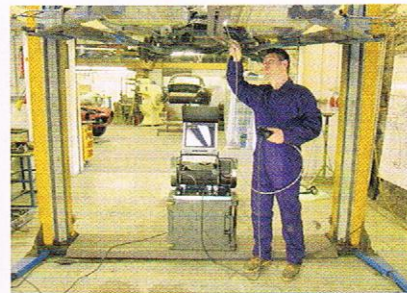
Diagnose: Alle Hohlräume werden per Endoskop untersucht. So bleibt keine versteckte Roststelle unentdeckt.
