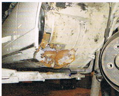
Nach dem Abstrahlen zeigt sich starker Rostbefall am Übergang zum Schweller.
